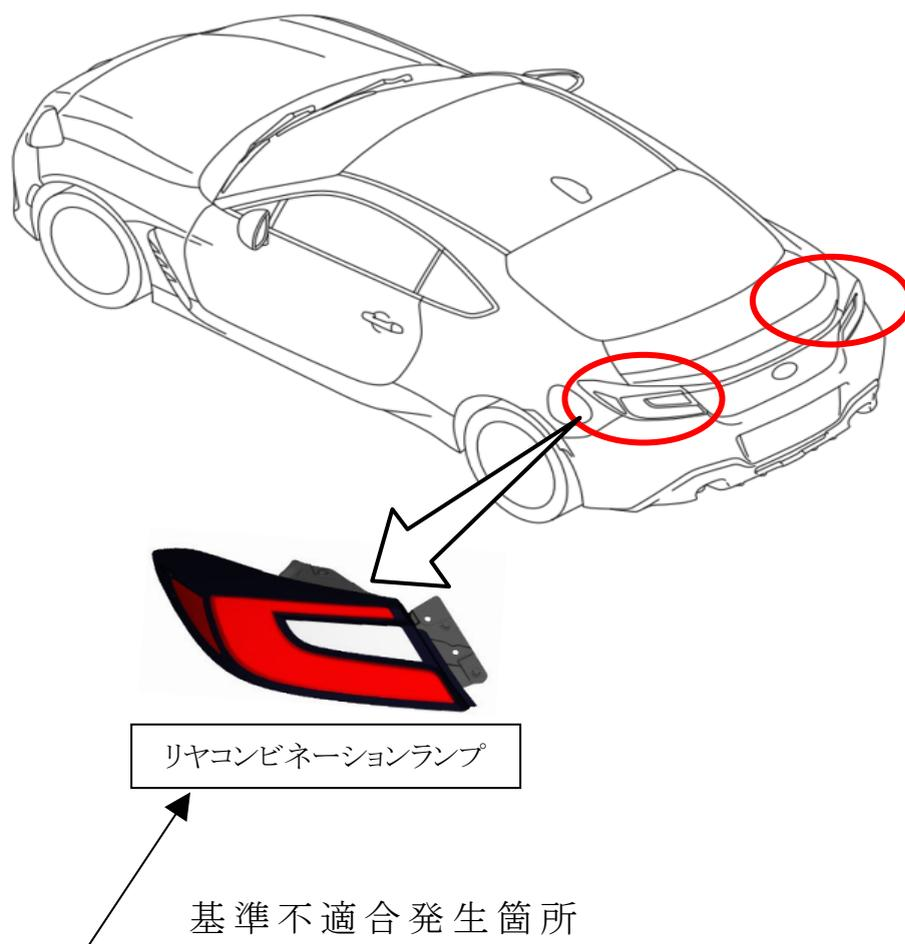
リヤコンビネーションランプにおいて、構成部品の電子回路設定が不十分なため、後面方向指示器及び後面非常点滅表示灯を点灯させるための電圧が上がりにくいことがある。そのため、後面方向指示器及び後面非常点滅表示灯が一時的に不点灯になるおそれがある。
