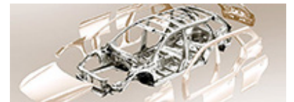
軽量化と強度を両立した「レガシィ」の軽量化ボディ
